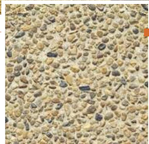
Detail des Finishes des Béton désactivé
